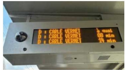
Une borne d'information voyageurs équipée d'un haut-parleur à la station de tramway Sainte-Germaine. TV
