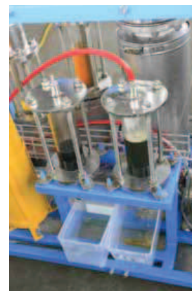
Les plastiques sont chauffés par pyrolyse et les fumées distillées. PHOTO S.P.
